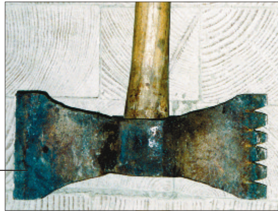
Doppelfläche mit einer Zahnschneide für Sandstein
