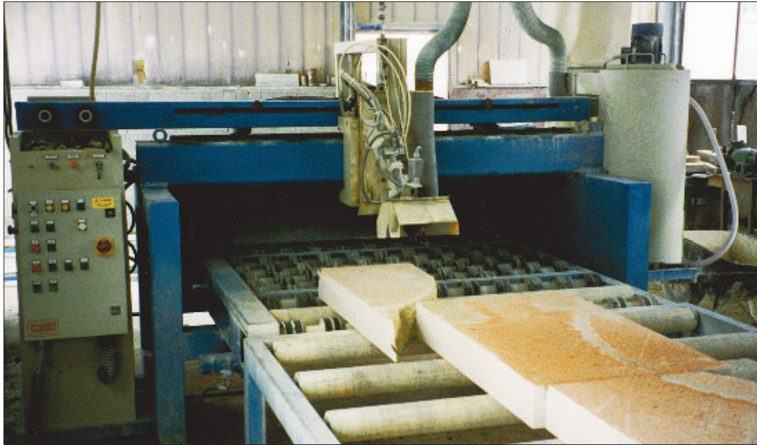
Kombimaschine zum Flammen, Stocken und Nadeln
